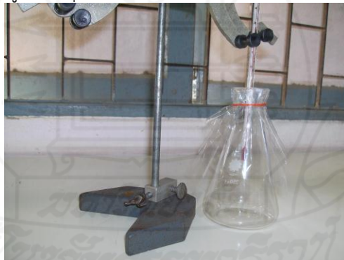
ภาพที่ 6.20 ภาพแสดงการเสียบเทอร์โมมิเตอร์ลงไปในช่วงรูปชมพู่ 4.2.4 นำเทอร์โมมิเตอร์และขวดรูปชมพู่ที่ปิดปากแล้วไปวางกลางแดด และนำเทอร์โมมิเตอร์อีกอันไปติดตั้งไว้ข้างๆ
