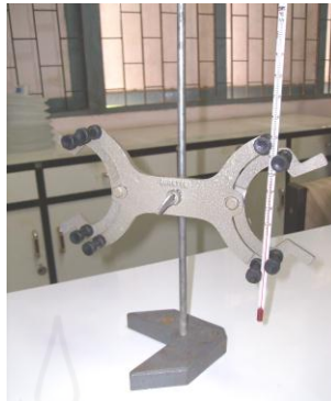
ภาพที่ 6.18 ภาพแสดงการติดตั้งเทอร์โมมิเตอร์บนขาตั้งปิวิเรต 4.2.2 ปิดปากขวดรูปชมพู่ด้วยถุงพลาสติกและรัดด้วยยาง
