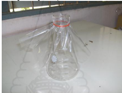
ภาพที่ 6.19 ภาพแสดงการปิดปากขวดด้วยถุงพลาสติกและรัดยาง 4.2.3 เจาะรูที่ปากถุงพลาสติกและเสียบเทอร์โมมิเตอร์ลงไปในช่วงรูปชมพู่
