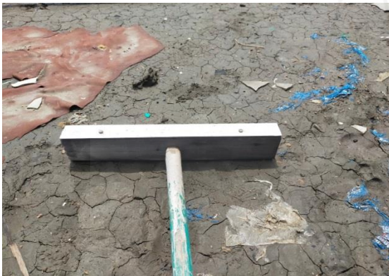
ภาพที่ 2.20 อีรูน(สำหรับรูนเกลือให้แตกเป็นเม็ด)
