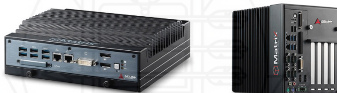
ภาพที่ 2.5 เครื่องคอมพิวเตอร์เกรดอุตสาหกรรมแบบฝั่งตัวประเภท Fanless
