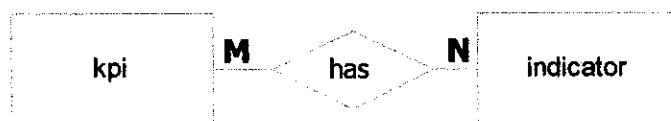
ภาพที่ 4.20 แสดงความสัมพันธ์ของเอนทิตี kpi และเอนทิตี indicator
