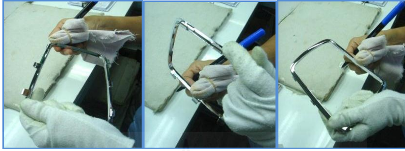
ภาพที่ 4.8 แสดงการตรวจสอบคุณภาพชิ้นงานหลังชุบโครเมียม
